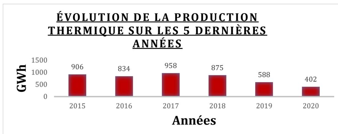
La hausse de la puissance importée du Ghana de 100 à 150 MW par la ligne d'interconnexion Ghana-Burkina en 2020 a entraîné une baisse significative de la production thermique de la SONABEL.
